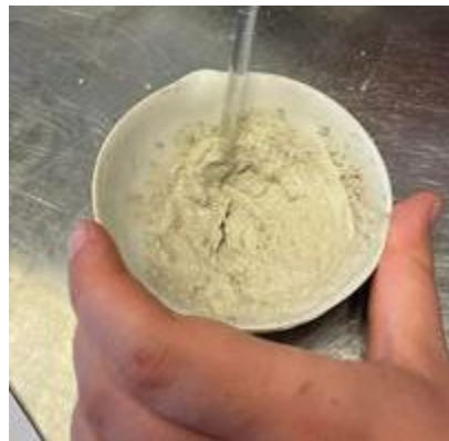
Billede-kalk 5 – Opblanding med vand
